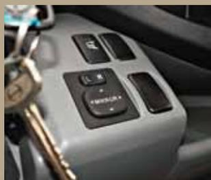
В комплектацию "Делюкс" входит электропривод регулировки боковых зеркал
