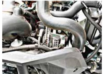
**При работе в мороз будет полезен генератор с повышенной силой тока**
