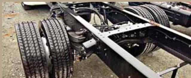
На автомобилях Hino серии 500 полной массой 12 тонн теперь устанавливают покрышки Bridgestone M788 265/70R19,5 140/138 M
