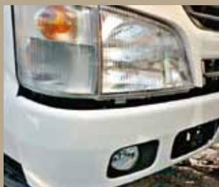
У машин 300-й серии с обычной кабиной бамперы окрашены в цвет кабины
